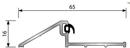
Seuil d'étanchéité en aluminium pour la partie basse des portes d'entrée. Utilisable en rénovation ou en neuf avec contreprofilage du pied dormant.
