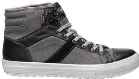
Poids : 595 g (pour une chaussure de taille 42). Embout en acier inoxydable 200 joules. Insert anti-perforation non métallique. Dessus toile et microfibre aspect cuir avec renfort du bout en microfibre. Tige première de propreté amovible en textile et mousse antibactérienne. Semelle PU double densité et semelle intermédiaire en polyuréthane. Chaussures antistatiques. Semelle résistante aux hydrocarbures. Norme EN ISO 20345 SRC.
